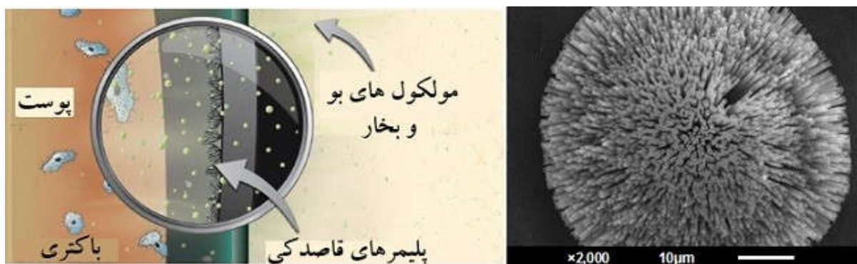
شکل 10- نحوه عملکرد پارچه‌های تکمیل شده با پلیمرهای قاصدکی.
