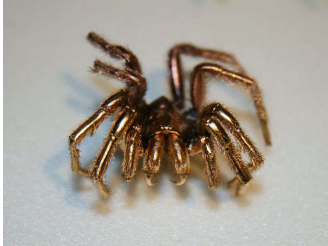
شکل 6- عنکبوت پوشش داده شده با طلا جهت بررسی با SEM
