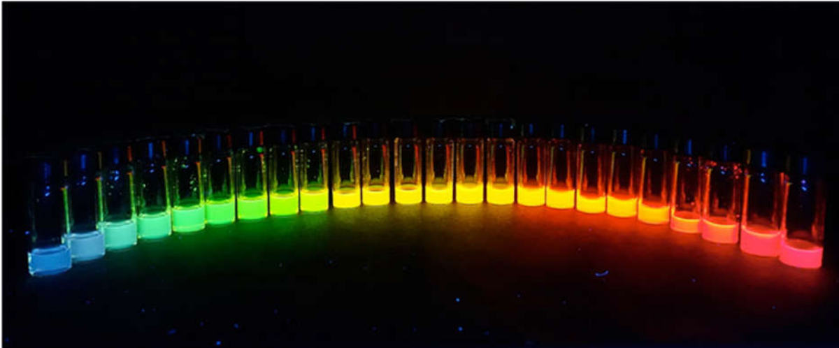
شکل 5- تصویری از نقاط کوانتومی با رنگ‌های مختلف (ناشی از اندازه و ترکیب شیمیایی مختلف آن‌ها).
