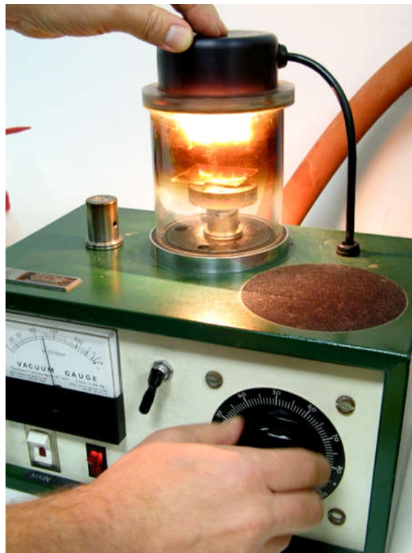
شکل 5- شمایی از دستگاه کندوپاش جهت پوشش‌دهی نمونه SEM
