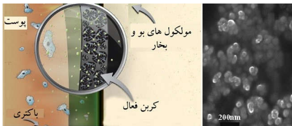
شکل 7- نحوه عملکرد پارچه‌های تکمیل شده با نانوذرات کربن فعال.
