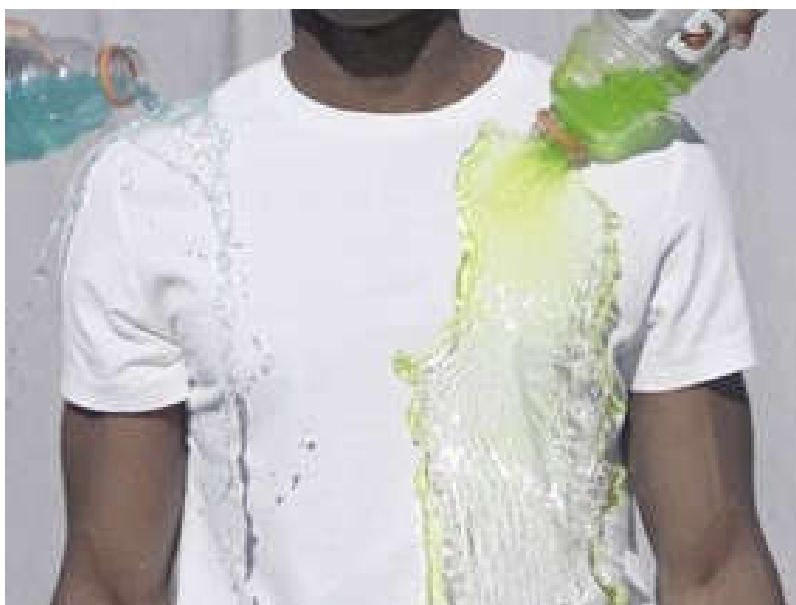
شکل 6- نمونه‌ای از یک لباس خودتمیزشونده با نانوذرات اکسید تیتانیوم.
