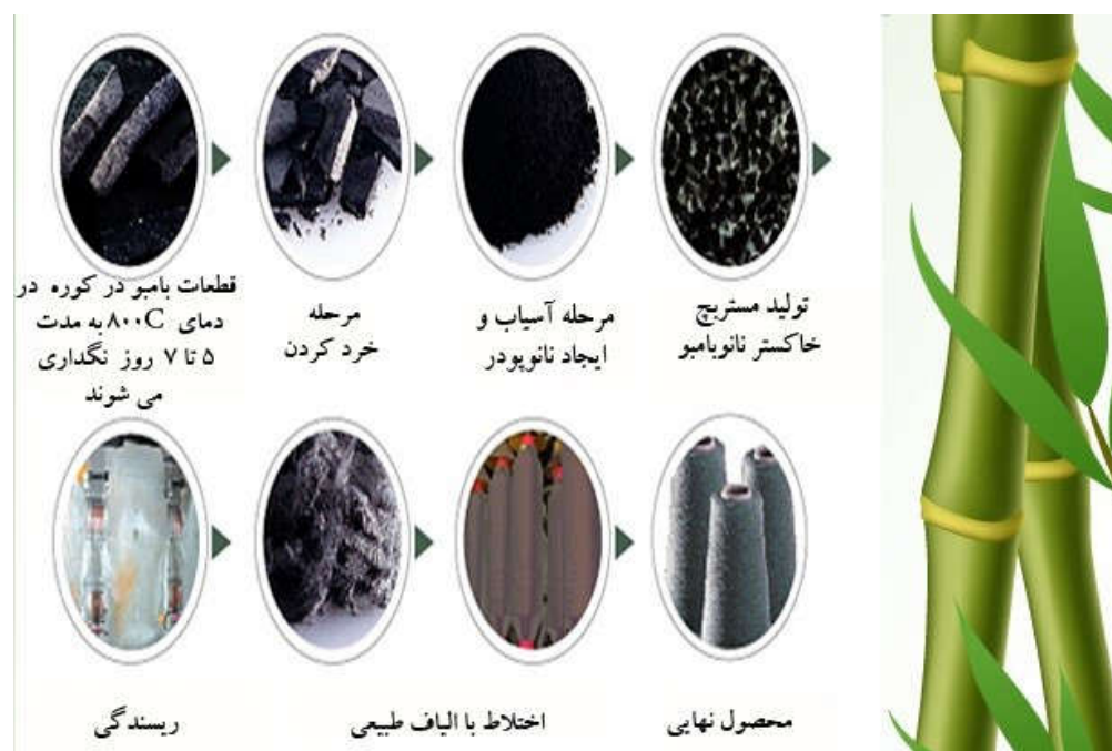
شکل 8- نحوه تولید الیاف با استفاده از خاکستر بامبو.
