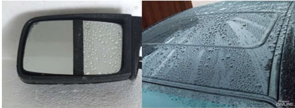
شکل 4- کاربرد TiO_2 در شیشه (الف) و آئینه (ب) خودتمیزشونده و ضد مه خودرو.
