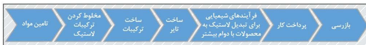
شکل 4- مراحل تولید لاستیک خودرو.
